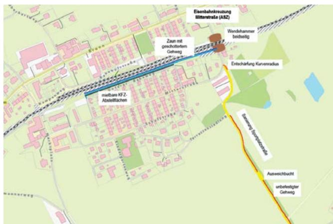
gesamte Länge ein unbefestigter Gehweg mit einem dazwischenliegenden mit Rasengittersteinen befestigten Sicherheitsstreifen errichtet. In der Mitte ist eine Ausweichbucht geplant.
